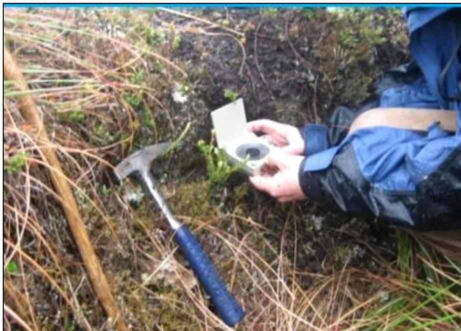
Fig. 39 Utilisation de boussole avec inclinomètre
