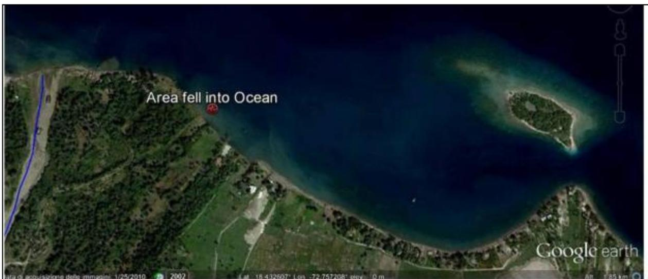
Fig. 18 Images Google Earth que montrent l'effondrement à cause de liquéfaction à Grand Goâve localité Petit Paradies à la zone d'embouchure de la Rivière de Grand Goâve, à gauche avant le séisme et à droite après le 12 Janvier 2012. (Sources données MarkoPolo, Jacen Solo, Google Community, 2010, <http://bbs.keyhole.com/ubb/ubbthreads.php?ubb=showprofile&User=290906>).
