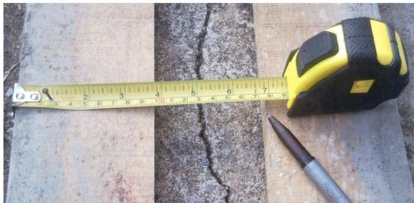
**Foto 2. Ejemplo de medidor con cinta métrica**
