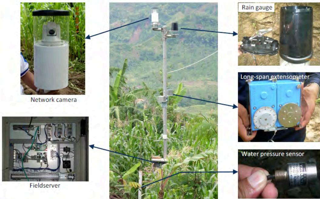
Figura 2. Mástil con with extensiómetros, pluviómetro gauge, medidor de presión de agua, cámara web, caja exterior con el servidor de campo. Fathani (2010)
