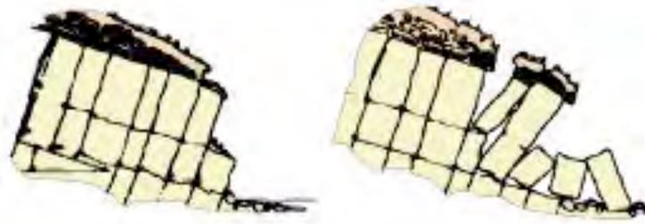
**Figura 2. Basculamiento de columnas.**
