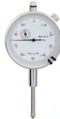
Para realizar rápido mediciones de aberturas de grietas en un edificio o en el suelo se lleva una tabla pesada de acero y se coloca muy cerca del objeto que se quiere monitorear. Se ajusta el reloj de medición para que el pin toque el objeto. Se baja palanca la en la base magnética del soporte para que imán conecte el soporte firmemente con la tabla de acero. Esta configuración se puede usar para varios días. Para mayor tiempo es mejor usar distanciómetros.
