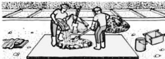
3. Agregar la grava y mezclar en forma envolvente hasta que se reparta en toda la liga, como se muestra en el dibujo.
