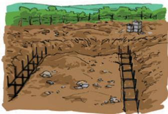
La cimentación es el elemento estructural que conecta la edificación con el terreno, y que traspasa al terreno todas las cargas(peso) de la misma.
